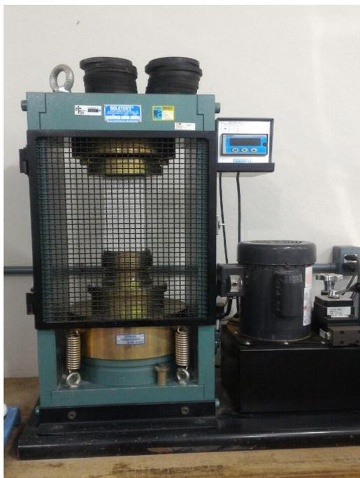
Figura 6 - Prensa hidráulica Marca Solotest com o corpo de prova
