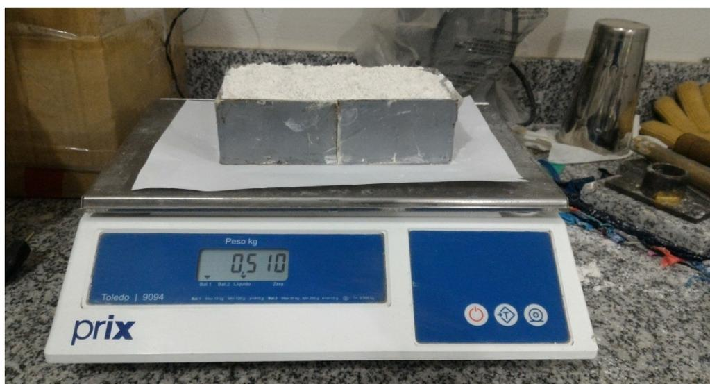
Figura 4 - Molde com resíduo de gesso não compactado.
